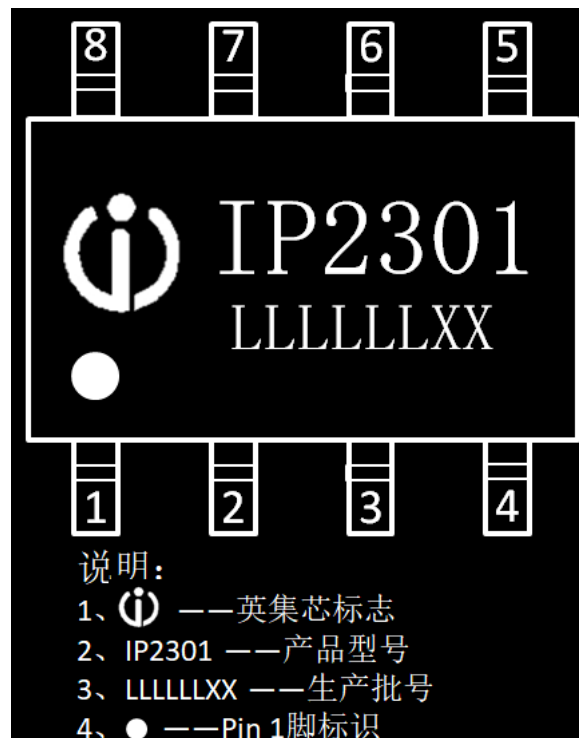
图 9 IP2301 IC 丝印说明(ESOP8)
