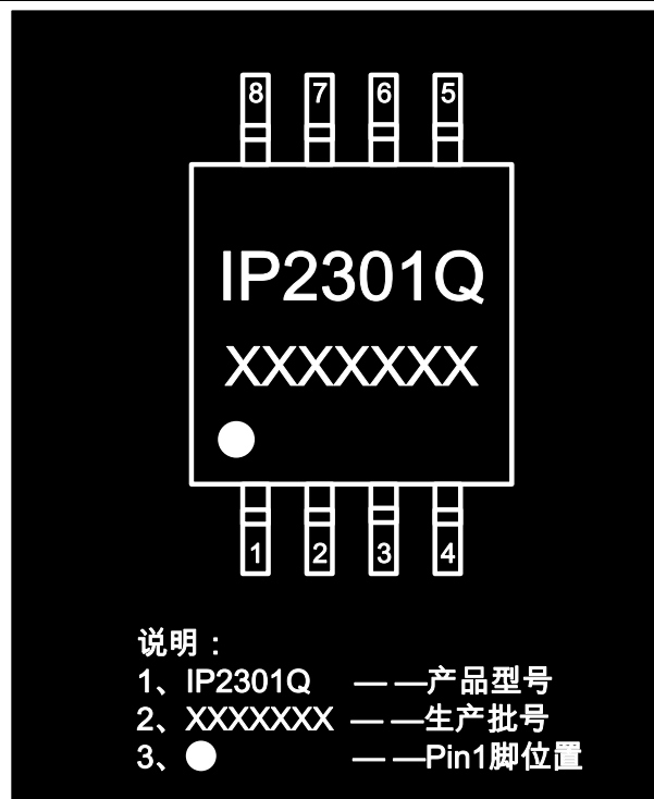
图 11 IP2301Q IC 丝印说明(CPC8)
