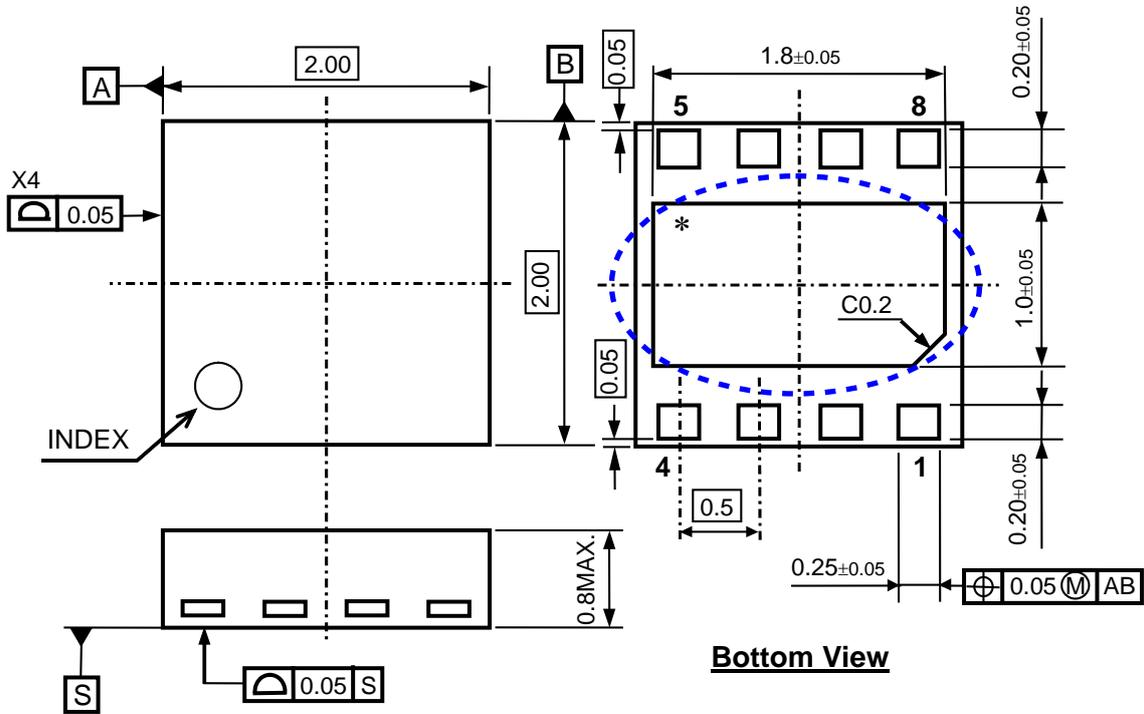
DFN2020-8 Package Dimensions (Unit: mm)
